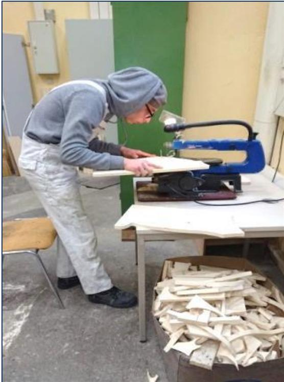
Die Konturen haben wir auf dem Leimholz aufgezeichnet und anschließend mit der De-Dekupiersäge und der Stichsäge ausgeschnitten.
